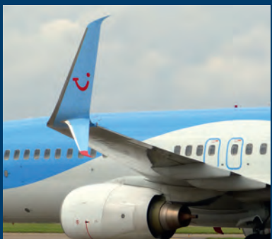
Alle vliegtuigen B737 zijn uitgerust met Split Scimitar Winglets.
